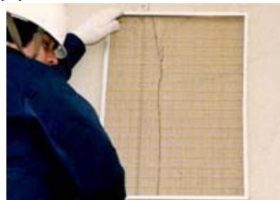
写真-4 クラックスケールによるひび割れの測定
