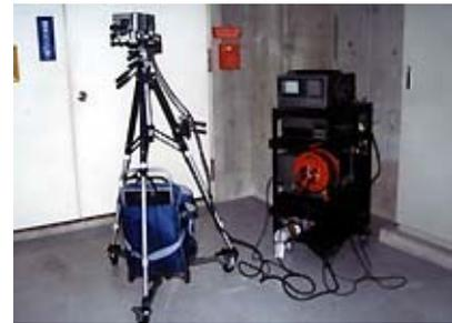
写真-19, 20 赤外線映像装置による画像、カラー写真により色分けで剥離部を探索でき
