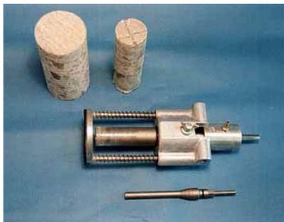
写真-2 中性化調査等のための梁型のコア抜き
