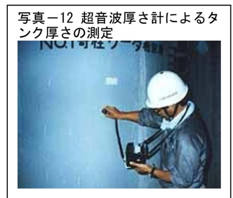
⑪もし、音速が不明試験材の厚さ測定の場合は、あらかじめ厚さのわかっている所または同一材質平板のテストピースで測定する。厚さと表示値の比  $K$  を求める。これを音速補正係数と言う。たとえば 10mm の厚さで表示値が 9.4mm とすると  $K=1.06$  である。試験材の表示値に  $K$  を掛ければ、厚さが求められる。表示値が 18.8 mm なら、厚さは 19.9 mm である。
