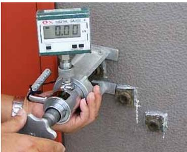
写真-17 サッシュ廻りシーリング材のサンプリング
