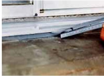
写真-18 笠木廻りシーリング材のサンプリング
