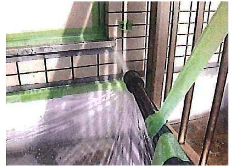
浸水口と思われるひび割れ部分に散水機の高圧水を吹き付ける。
