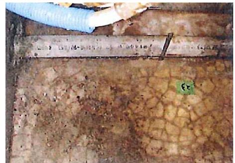
散水試験の結果、パイプスペースの床に水が流れ込んだ。
